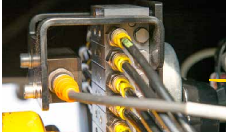
På engcons tiltrotatorer sidder gravesystemets tiltsensor på et lettilgængeligt sted.
