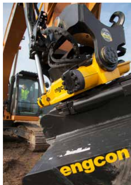
På Leicas testområde finder vi en Case CX210C gravemaskine, som er udstyret med en engcon EC226 tiltrotator med ePS (engcon Positioning System) og Leicas seneste maskinstyring Icon 3D.
