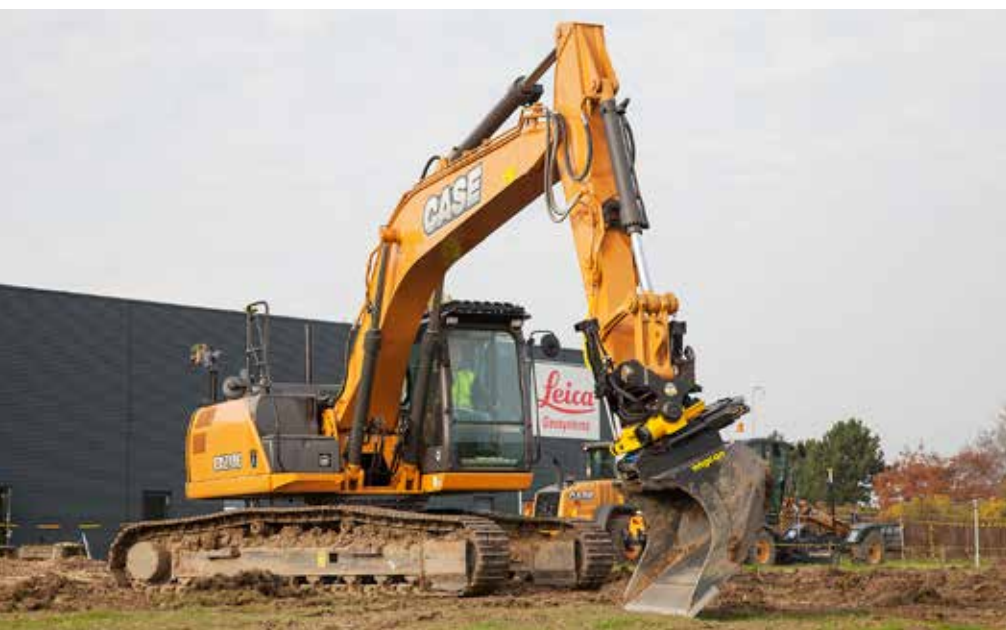
På Leicas testområde finder vi en Case CX210C gravemaskine, som er udstyret med en engcon EC226 tiltrotator med ePS (engcon Positioning System) og Leicas seneste maskinstyring Icon 3D.
