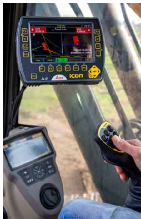
Mens Lars graver, kan vi nøje følge skovlens bevægelser på den store skærm i kabinen.
