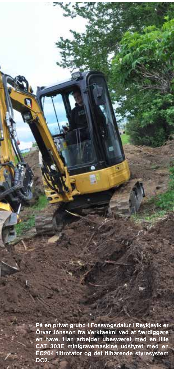
Det proportionale styresystem DC2 (Digging Control) styres ved hjælp af ergonomiske joystick. Örvars minigravemaskine var verdens første i sin størrelse med systemet.
