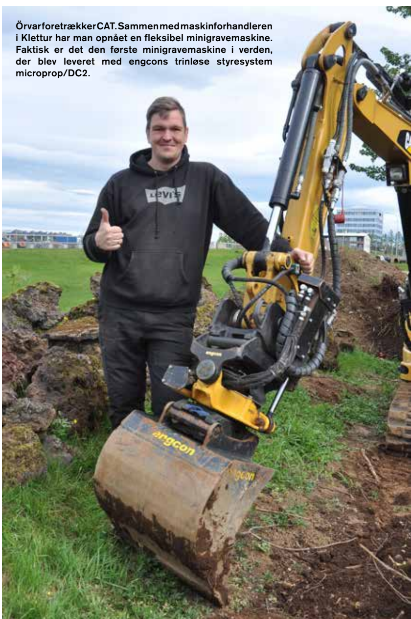
På en privat grund i Fossvogsdalur i Reykjavík er Örvar Jónsson frá Verktaekni ved at færdiggøre en have. Han arbejder ubesværet med en lille CAT 303E minigravemaskine udstyret med en EC204 tiltrotator og det tilhørende styresystem DC2.
