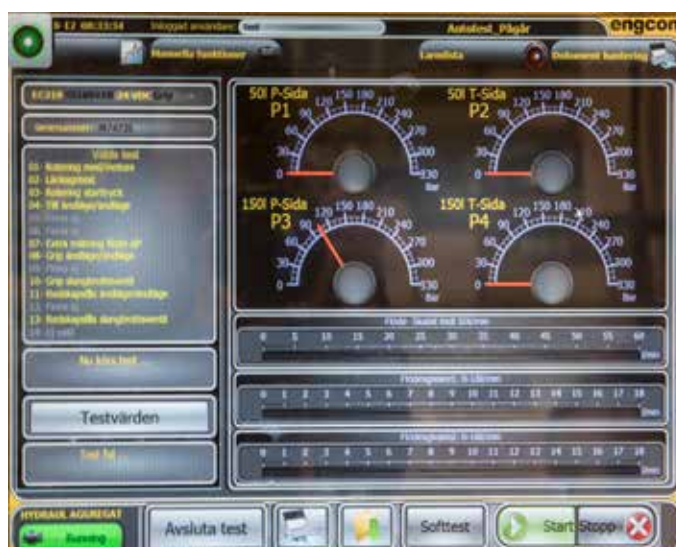
▲ Alle tiltrotatorer gennemgår en identisk testprocedure, som styres af et forprogrammeret computerprogram udviklet specielt til engcon.
