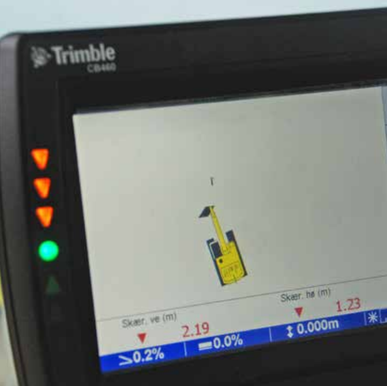
Det nye ePS-system som her er koblet op på Trimble maskinstyring betyder, at føreren kan se skovlens rotation og tilt på monitoren.
