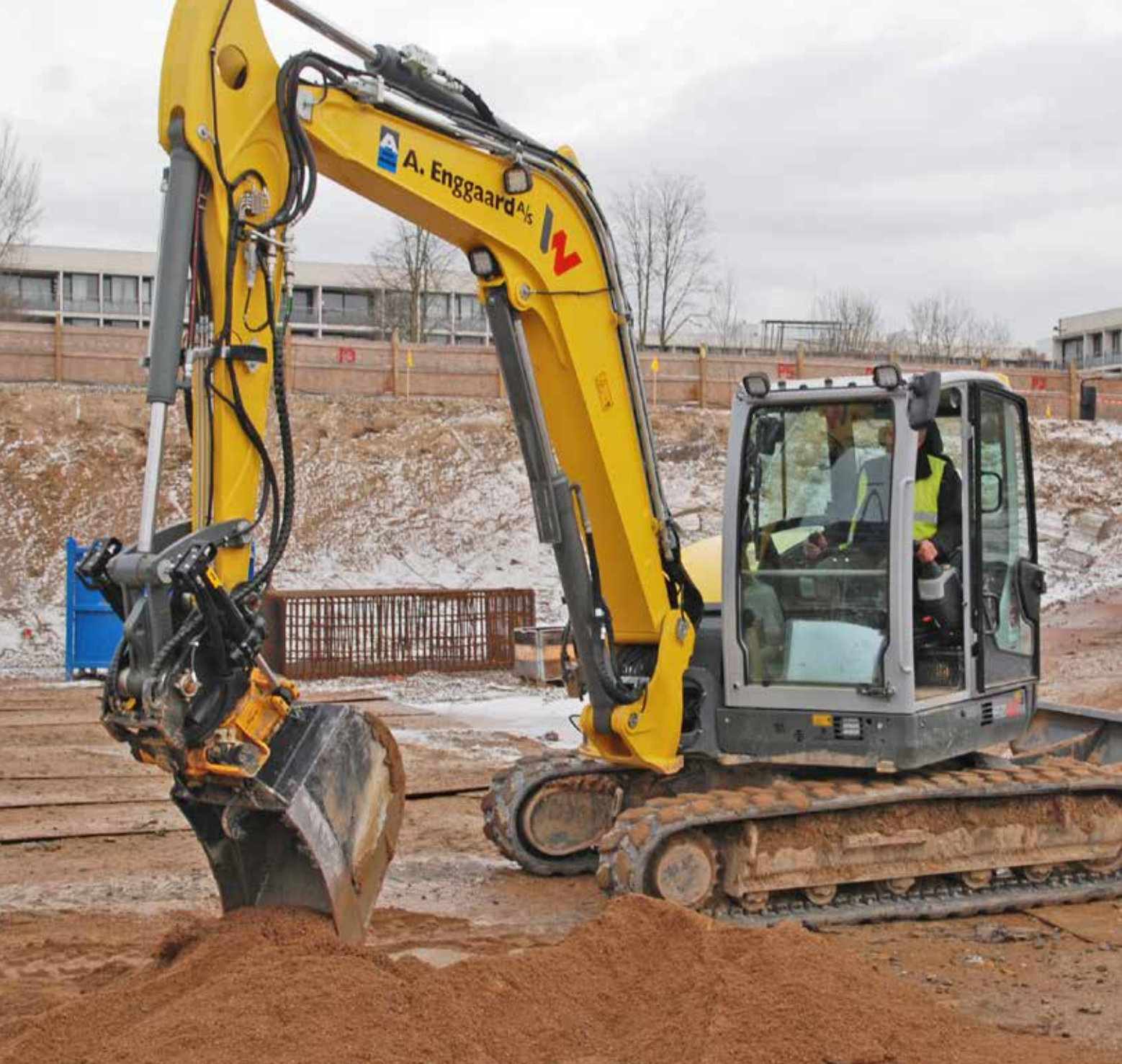
A. Enggaards nye CZ80 kører på en stor byggeplads i Aarhus. Den er ligesom EW100 forsynet med engcon EC209 og har Microprop styring og MIG2 joystick.
