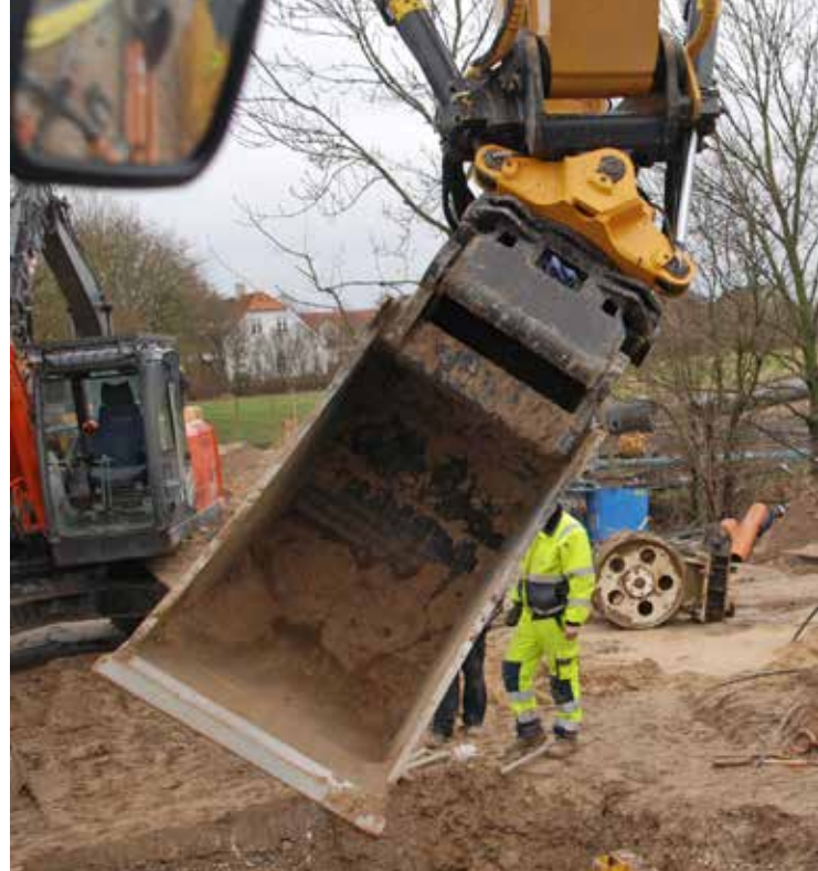
Det nye ePS-system som her er koblet op på Trimble maskinstyring betyder, at føreren kan se skovlens rotation og tilt på monitoren.
