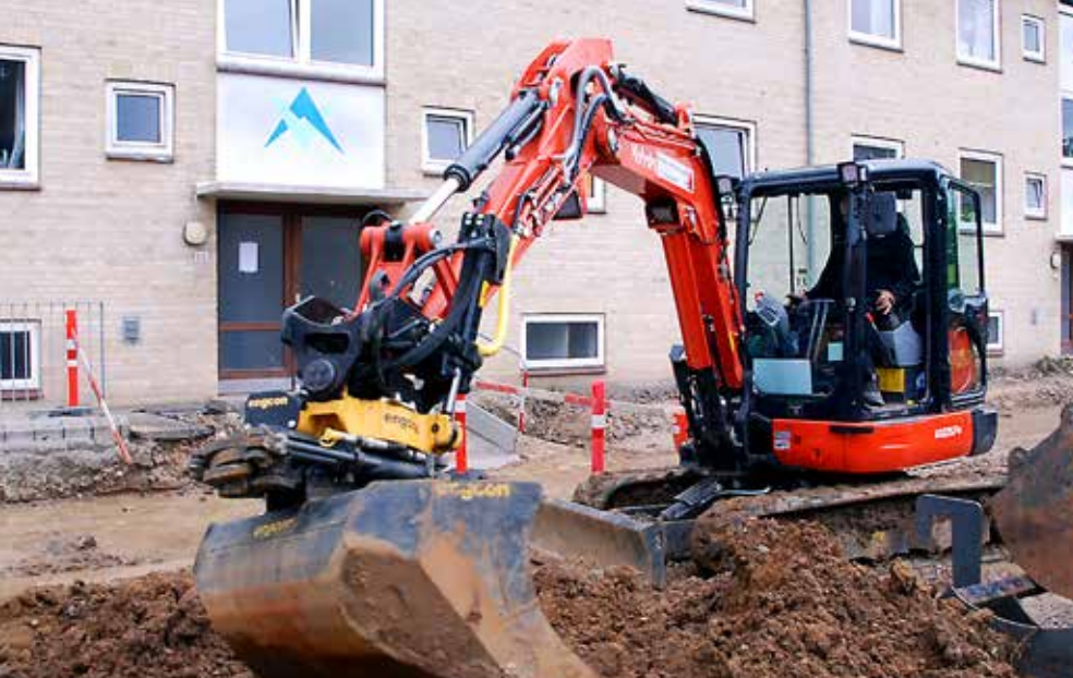
Tiltrotatoren med gribeklo er med til at gøre den 5,7 tons Kubota til en meget fleksibel maskine.
