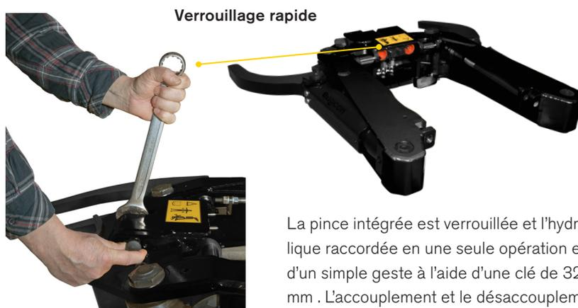
La pince intégrée est verrouillée et l'hydraulique raccordée en une seule opération et d'un simple geste à l'aide d'une clé de 32 mm. L'accouplement et le désaccouplement s'effectuent en moins d'une minute.
